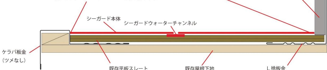
**流方向雨押えの納まり** 既存平板スレートが以下の3種で納まっているので以下の方法でそれぞれ納めてください
